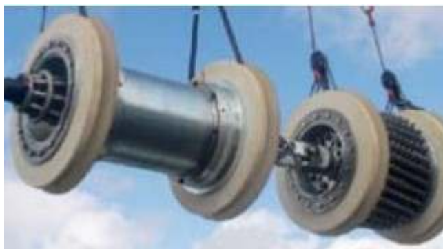
図 2. JFE エンジニアリング社が開発した超音波検査ピグ (出所：JFE エンジニアリング株式会社パンフレット)
